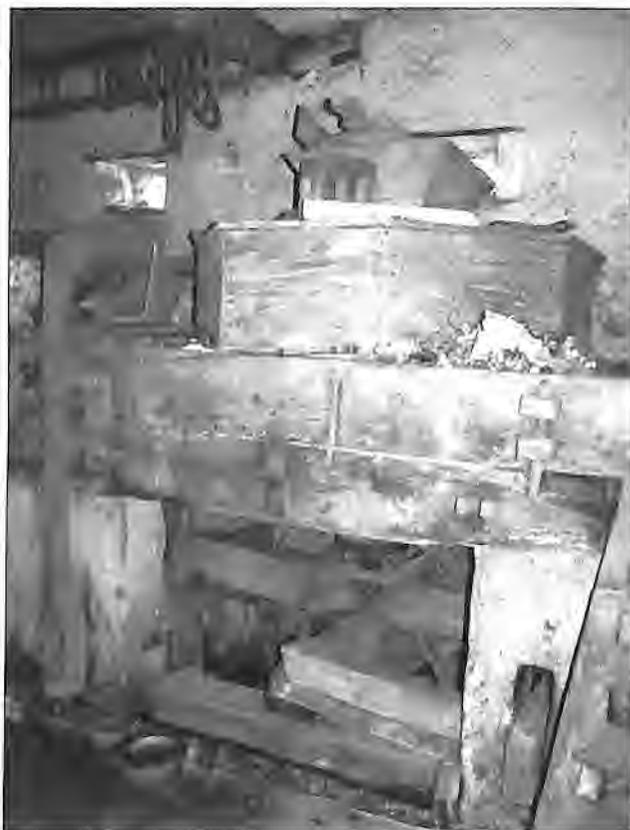
Fig. 8. Moulin des Michelies (Allemans). Ensemble complet avec rouet, lanterne, banc de lève, archure et trémie.
