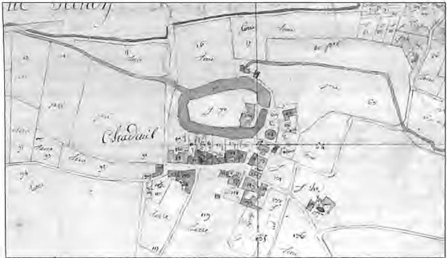
Fig. 37. Château de Chapdeuil. L'eau de l'Euhe est dérivée pour alimenter les douves (cadastre de 1809, section A1).
