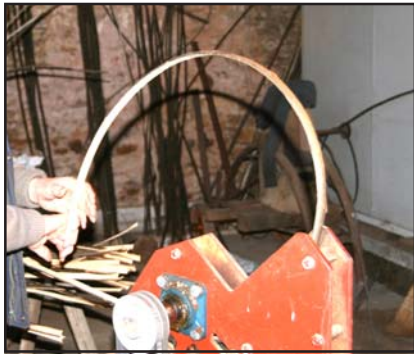
Cintrage d'une tige de feuillard sur une cintruse électrique.
